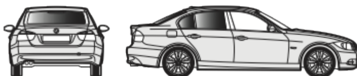
Vier deurs sedan, 1 achterrauit en 2x portier (zonder driehoek ruit in de achterportier) en 2x achter
